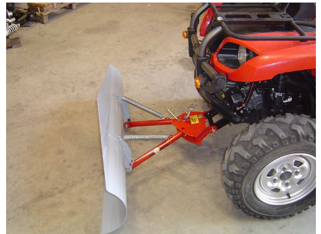
Pala delantera 1,2 m serie ligera con elevador eléctrico
