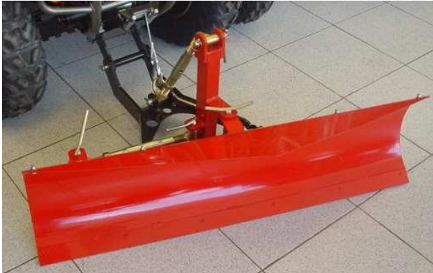
Pala delantera 1,2 m con elevador eléctrico
