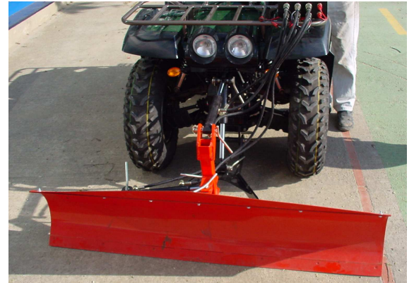
Pala delantera 1,5 m con elevador hidráulico
