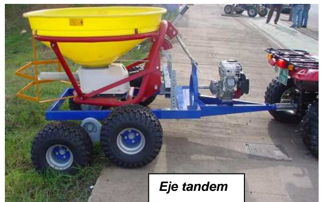
Eje regulable en anchura y posición respecto al chasis
