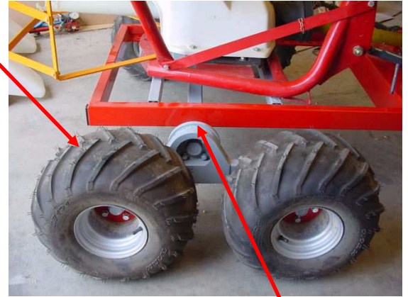
Eje regulable en anchura y posición respecto al chasis
