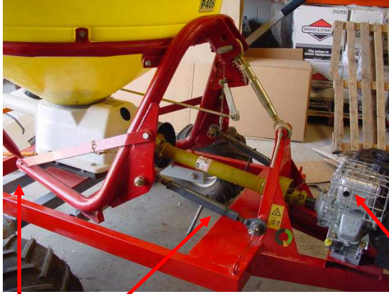
Anclajes regulables en anchura, altura y posición respecto al chasis
